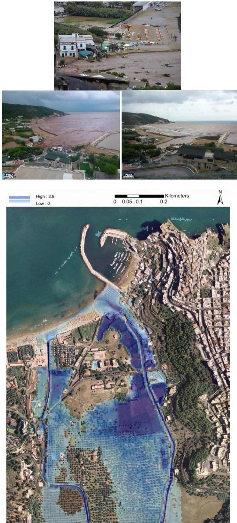
Figura 1.12 - Confronto tra le foto dell'alluvione di Peschici del 6 settembre 2014 e la ricostruzione dell'impronta dell'area allagata con il modello idraulico
